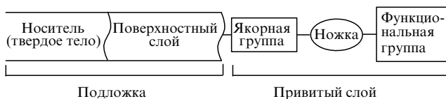
Рис. 1. Строение поверхности химически модифицированного носителя.
